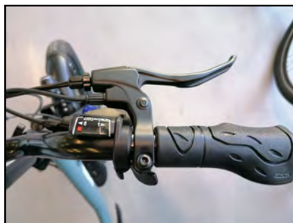
Figura 9 – Posizione dei comandi/indicatore del cambio.
