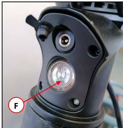
Figura 8 – Pulsante di accensione/spegnimento batteria.
