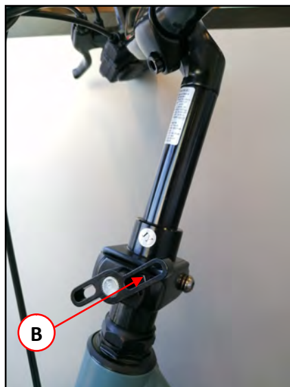
Figura 2 – Sede dello stelo del manubrio e manettino di fissaggio del manubrio.
