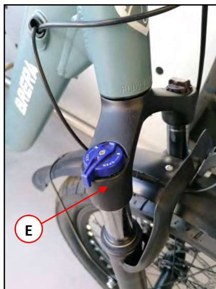
Figura 7 – Regolazione della sospensione.
