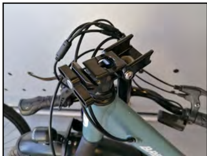
Figura 2 – Sede dello stelo del manubrio e manettino di fissaggio del manubrio.
