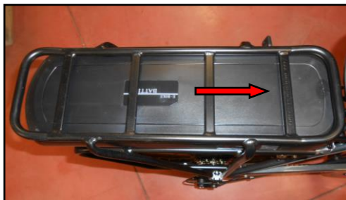
Figura 5 – Senso di installazione batteria.
