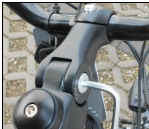
Figura 3 – Regolazione altezza manubrio.
