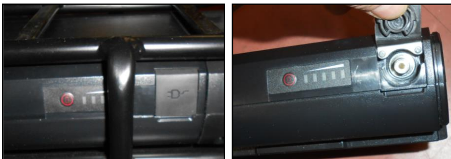
Figura 12 – Presa carica batteria.
