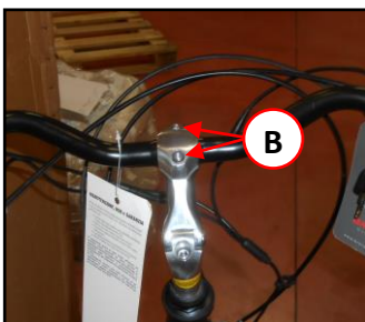
Figura 2 – Viti di fissaggio rotazione longitudinale manubrio.
