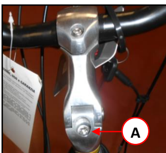
Figura 1 – Vite fissaggio rotazione manubrio.
