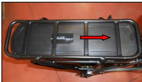
Figura 3 – Senso di installazione batteria.
