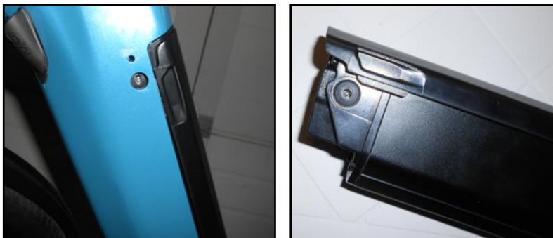
Figura 9 – Presa carica batteria.
