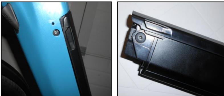
Figura 9 – Presa carica batteria.
