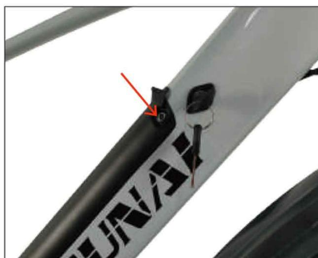
Conexión de carga de batería
