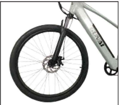
5.3.3 Inserte el eje de liberación rápida en el muelle y apriete el tornillo (la tuerca de liberación rápida debe estar en el mismo extremo que el freno).
