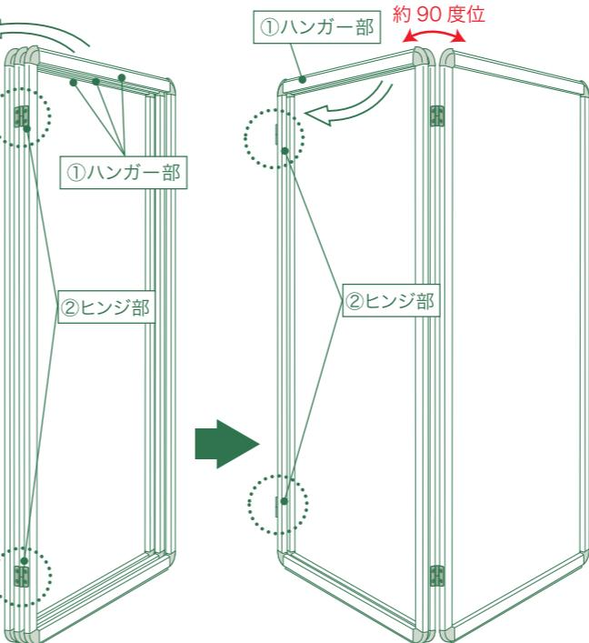
下図のように、①ハンガー部に、衣類をかけることができます。①ハンガー部と③脚部は柔軟性のある樹脂でガードしていますので、衣類のズレ防止や掛けた時の金属音軽減、床への傷つき防止の効果がございます。パネルは約90度程度開いてご使用頂くと、耐荷重が最大の状態となります。
