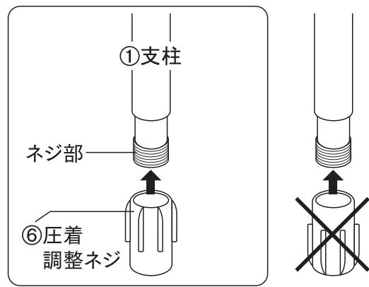
\*⑥圧着調整ネジの挿入する向きに注意。正しく挿入しなければ圧着板が差し込めません。
