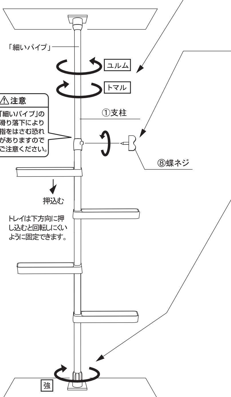
① ①支柱の「細いパイプ」を「ユルム」の方向に回してから、天井までいっぱいに伸ばし、次に「トマル」の方向に回して、しっかりと固定します。
