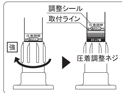
※ 圧着調整は、調整シールの「ストップ線」までにしてください。
