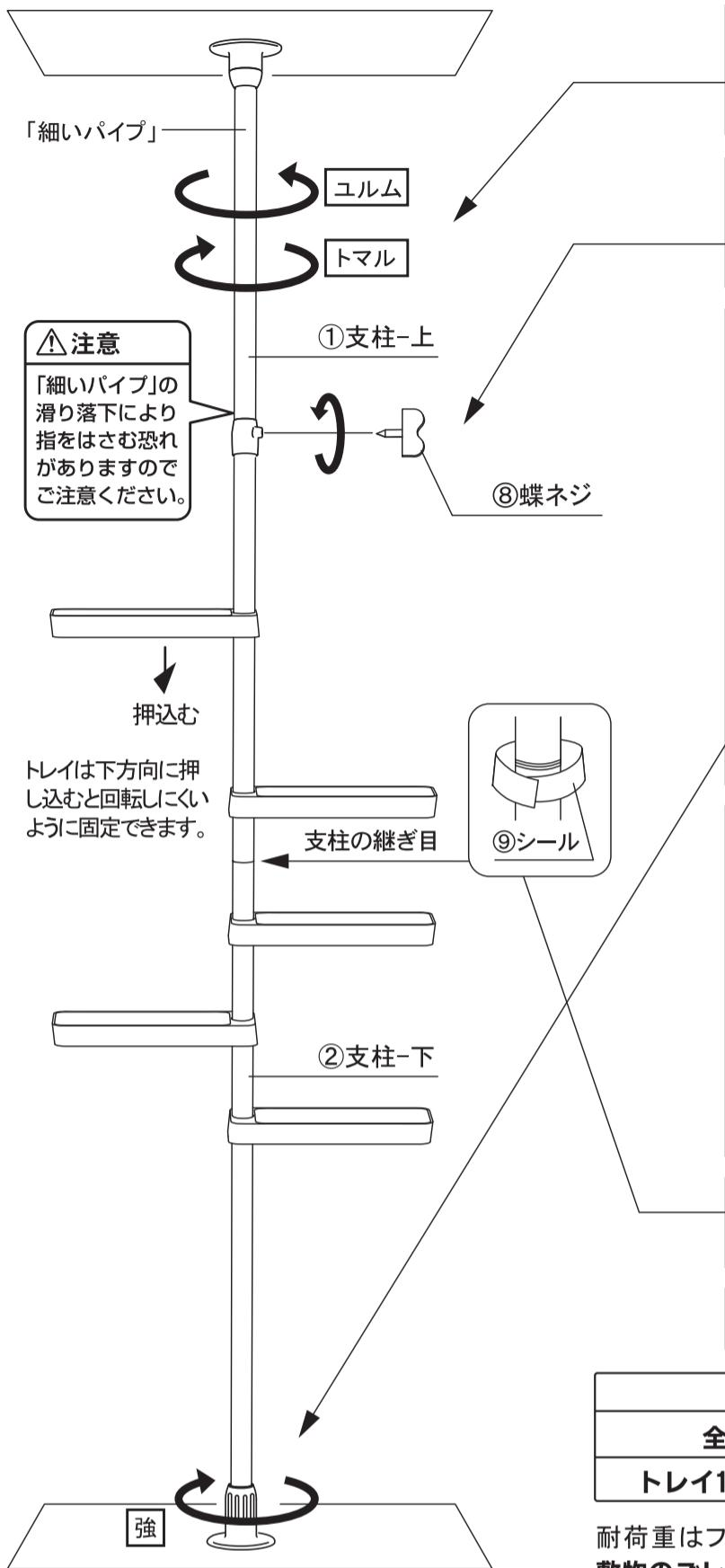
① ①支柱-上の「細いパイプ」を「ユルム」の方向に回してから、天井までいっぱいに伸ばし、次に「トマル」の方向に回して、しっかりと固定します。
