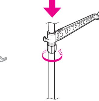
調節後、キャップを矢印の方向へまわして締め、
