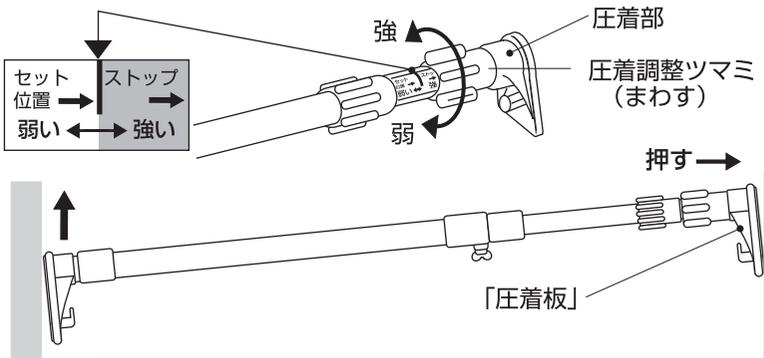
注) 圧着板の向きは、必ず左図のように垂直方向に取付けてください。
