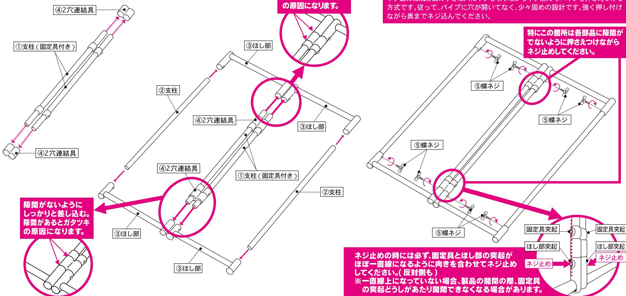
ねじ止めの時には必ず、固定具とほし部の突起が
