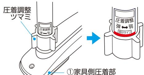
圧着調整ツマミを「強・弱シール」にある「強」の方向にまわし、圧着調整ツマミの端をいったん取付ラインに合わせておきます。
