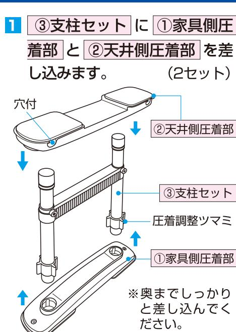
2 圧着調整ツマミを「強」の方向にまわし、「取付ライン」の位置に合わせます。
