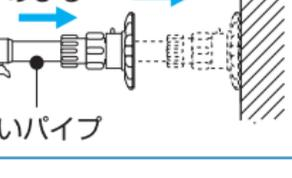
次に細いパイプを両端のキャップが壁面にあたるまでのばします。
