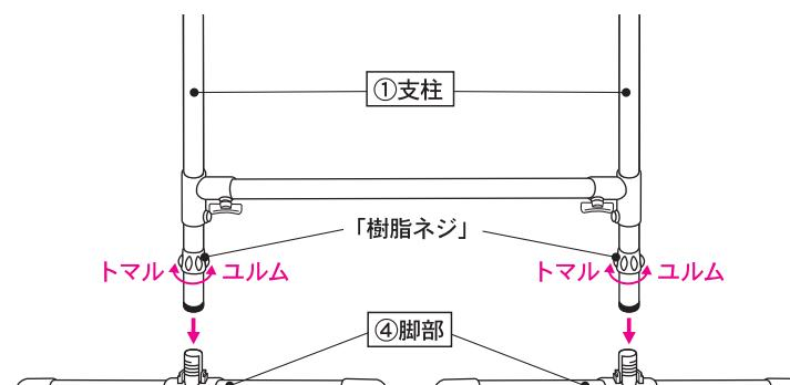
3 ④脚部に付いている「樹脂ネジ」を「ユルム」の方向に回して、一旦、取り外し、図の様に「樹脂ネジ」を①支柱に通してから、①支柱を④脚部へ奥まで差し込みます。
