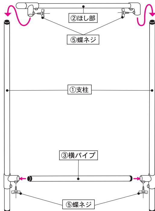
1 図のようにフラットな床に置いて③横パイプを①支柱へ差し込み、次に、②ほし部を①支柱へ差し込みます。
