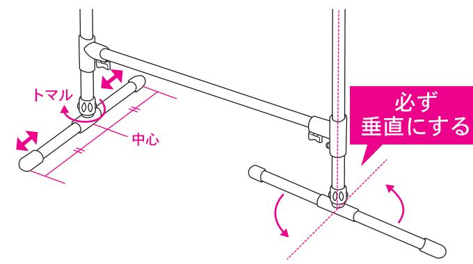
5 ④脚部 パイプはスライドしますので、真中にパイプを移動させて、「樹脂ネジ」を「トマル」の方向へ回して固定してください。
