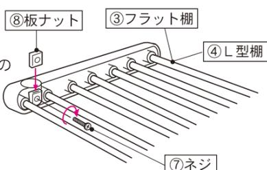
**3** **1**で**⑦ネジ**をセットした**③フラット棚****④L型棚**を**①支柱-上**に図のように挿入し、**⑦ネジ**で軽くネジ止めます。※「L型棚」が上になるように入れかえて挿入されても結構です。
