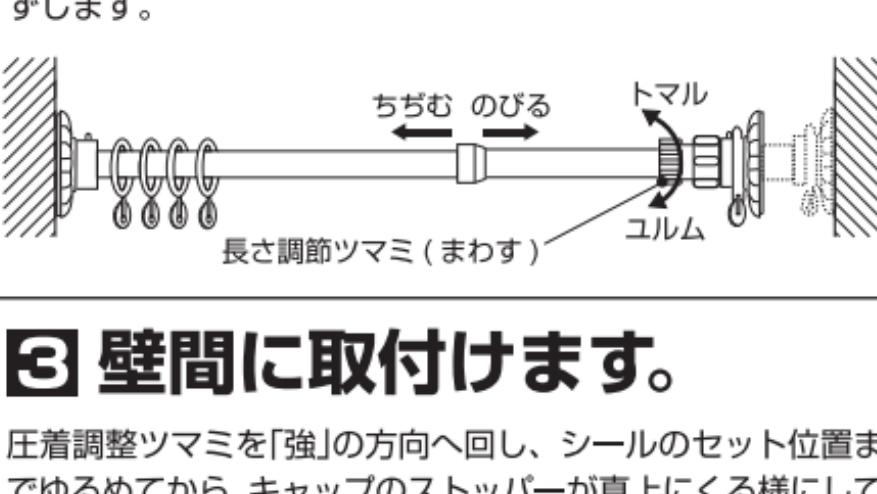
リングを1つだけはずしてから、圧着キャップのストッパーにリングを引っ掛けて、圧着キャップを圧着調整ツマミに差込んでください。次に、残りのリングをポールに通した状態で、もう1つの圧着キャップを、圧着調整ツマミの反対側に差込んでください。
