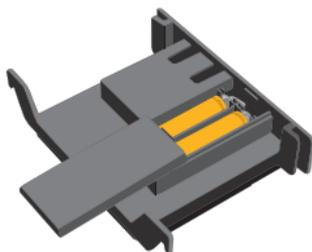
5. Setzen Sie die Scannerbox oben auf das Leuchtfeld. Vergewissern Sie sich, dass die Scannerbox in die Leuchtplatte eingeklinkt ist, damit sie verbunden ist.
