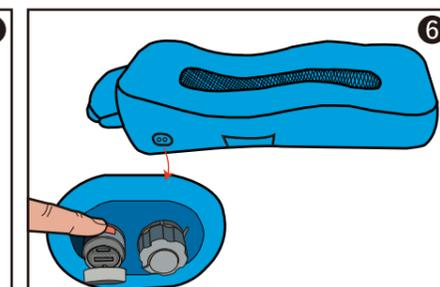
⑥図 5 の状態になったら、空気取り込み口のキャップを閉じてからスイッチを再度押し、電動空気ポンプを止めてください。
