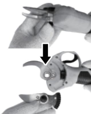
4. Spingere il perno di posizionamento con il dito, quindi rimuoverlo e togliere l'insieme della lama superiore.
