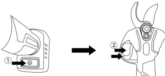
2. Dopo aver installato la batteria nel potatore elettrico, premi l'interruttore di accensione del potatore (nota: non premere a lungo) e ascolta il segnale acustico del buzzer. Successivamente, premi due volte consecutivamente il grilletto per attivare il potatore.
