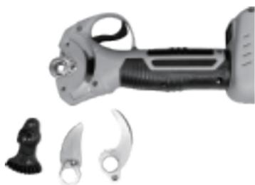
**Nota:** Quando si installa l'insieme della lama superiore e inferiore, assicurarsi che la forma del perno di posizionamento e dell'incavo di posizionamento siano allineate correttamente. Se il perno di posizionamento non si inserisce correttamente, ruotarlo semplicemente fino a quando si blocca in posizione.
