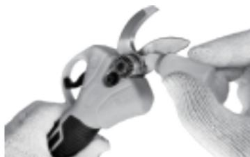
1. Mantenere le lame aperte durante l'applicazione del lubrificante.
