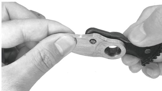
4. Separe el brazo de soporte de la cuchilla superior (si la cuchilla está demasiado apretada contra el brazo de soporte, utilice una llave Allen para golpear suavemente el brazo de soporte y aflojar la cuchilla superior).
