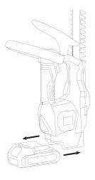
Pour installer le bloc-batterie dans la poignée de l'outil, alignez le bloc-batterie avec les rails à l'intérieur de la poignée de l'outil et faites-le glisser dans la poignée jusqu'à ce que le bloc-batterie soit fermement installé dans l'outil et assurez-vous qu'il ne se désengage pas.
