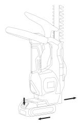
Pour retirer le bloc-batterie de l'outil, appuyez sur le bouton de déverrouillage et tirez fermement le bloc-batterie hors de la poignée de l'outil.
