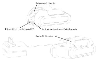
Per caricare la batteria, utilizzare l'adattatore in dotazione, che richiede circa 2 ore per una singola carica completa (nota: l'interfaccia di ricarica si trova nella posizione mostrata nella figura precedente).
