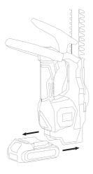
Per installare la batteria nell'impugnatura dell'utensile, allinearla con le guide all'interno dell'impugnatura dell'utensile e farla scorrere nell'impugnatura fino a quando la batteria è saldamente inserita nell'utensile e assicurarsi che non si sganci.
