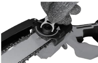
2. Rgire la tuerca en sentido antihorario para aflojarla. La cadena se bloqueará automáticamente en su lugar (No es necesario quitar la tuerca, solo aflojarla). Después de que la cadena se bloquee automáticamente, apriete la tuerca en sentido horario.
