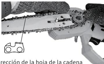
2. Instale la placa guía y la cadena para asegurarse de que la dirección de la hoja de la cadena sea correcta.
