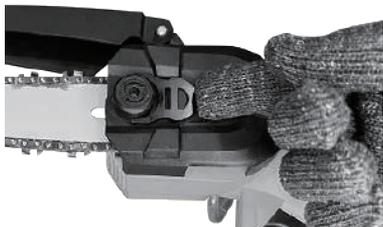
1. Levanta el mango de la tuerca de cubierta.
