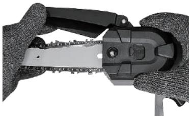
4. Al cubrir la placa de cubierta, levanta el guardabarros hacia arriba y luego coloca la placa de cubierta en su lugar.
