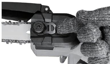
1. Levanta el mango de la tuerca de la cubierta.
