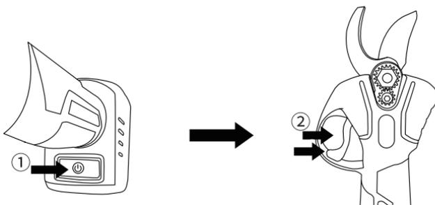
2. Après avoir installé la batterie dans la cisaille électrique, appuyez sur l'interrupteur de mise sous tension de la cisaille (note : pas d'appui prolongé) et écoutez le signal sonore du buzzer. Ensuite, appuyez deux fois consécutivement sur la
