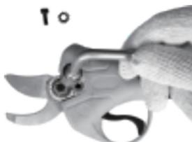
3. Utilisez une douille hexagonale pour tourner l'écrou dans le sens antihoraire et le desserrer, puis retirez-le.
