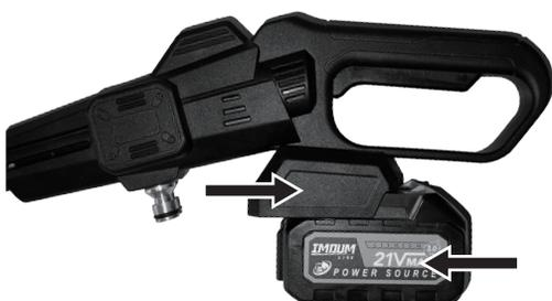
Paso 1: Como se muestra en la figura, inserte el paquete de baterías en la máquina adecuadamente, el tiempo de carga es de unas 3 horas para estar completamente cargado, por favor no lo cargue en exceso.
