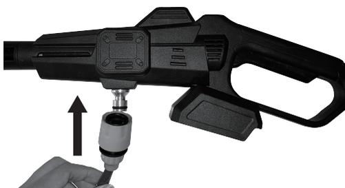
Paso 3: Como se muestra en la figura, inserte el conector de la llave (hay una junta de estanqueidad en el conector, compruebe si está en buen estado) en la máquina (si no está instalado en su sitio, la máquina no absorberá el agua, no funcionará y no tendrá presión).
