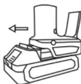
Legen Sie den Akku in den Kontrollbereich an der Unterseite der Stange ein, um sicherzustellen, dass der Akku nicht versehentlich herausfallen kann.
