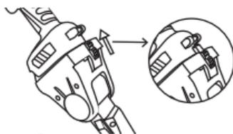
Klappen Sie den Sicherheitsverschluss des Anschlussmoduls nach oben, damit das Gerät nicht herunterfallen kann.
