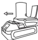
Insérez la batterie dans la zone de contrôle située au bas de la perche pour vous assurer que la batterie ne tombe pas accidentellement.
