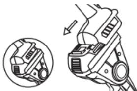
Insérez l'appareil dans le module de connexion de la perche et assurez-vous que l'interrupteur verrouille le produit.
