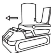
Inserte el paquete de batería en el área de control en la parte inferior del poste para asegurarse de que la batería no se caiga accidentalmente.
