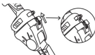
Mueva hacia arriba el pestillo de seguridad del módulo de conexión para evitar que el dispositivo se caiga.
