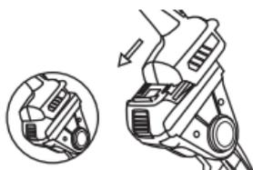
Inserte el dispositivo en el módulo de conexión de polos y asegúrese de que el interruptor bloquee el dispositivo.
