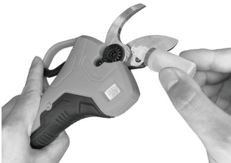
1. Mantenere le lame aperte durante l'applicazione del lubrificante.
