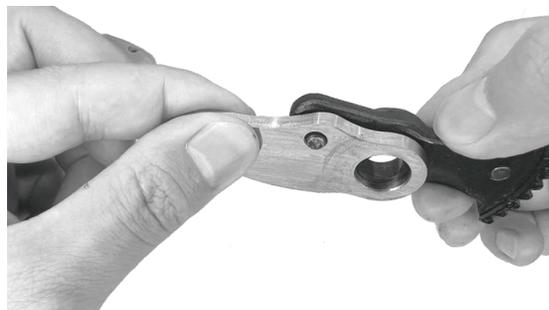
4. Separare il braccio di supporto dalla lama superiore (se la lama è troppo stretta contro il braccio di supporto, utilizzare una chiave a brugola per picchiettarla delicatamente il braccio di supporto e allentare la lama superiore).
