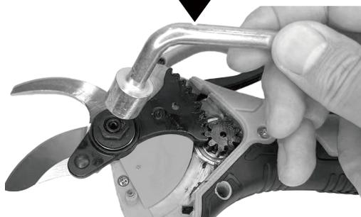
2. Svitare la vite dell'albero fisso in senso antiorario con una chiave esagonale adatta e rimuovere la rondella, quindi svitare la vite dell'albero in senso orario con una chiave esagonale e rimuovere il distanziatore dall'albero.
