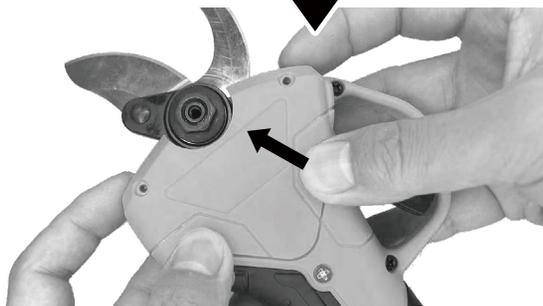
1. Svitare le viti con un cacciavite a croce e spingere la protezione dell'ingranaggio della lama verso l'alto per rimuoverla.
