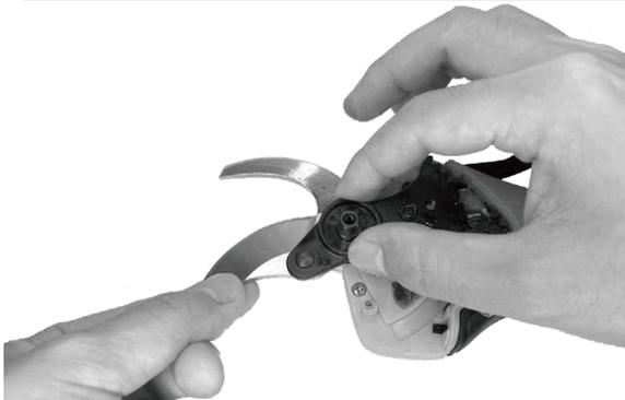
3. Entfernen Sie die obere Klinge (wenn die Klinge zu fest sitzt, klopfen Sie mit einem Innensechskantschlüssel darauf, um sie zu lösen und entfernen Sie sie).
