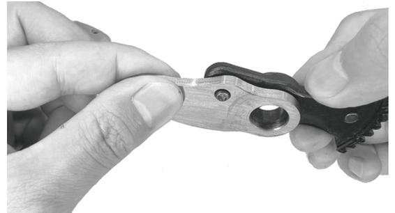
4. Trennen Sie den Stützarm von der oberen Klinge (wenn die Klinge zu fest am Stützarm sitzt, klopfen Sie mit einem Innensechskantschlüssel vorsichtig auf den Stützarm, um die obere Klinge zu lösen).
