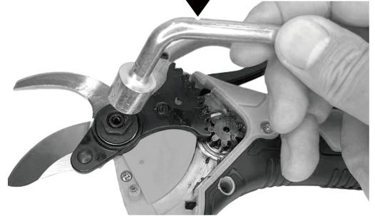
2. Lösen Sie die Schraube der festen Welle mit einem passenden Sechskantschlüssel gegen den Uhrzeigersinn und entfernen Sie die Unterlegscheibe, dann lösen Sie die Schraube der Welle mit einem Innensechskantschlüssel gegen den Uhrzeigersinn und entfernen Sie das Distanzstück von der Welle.
