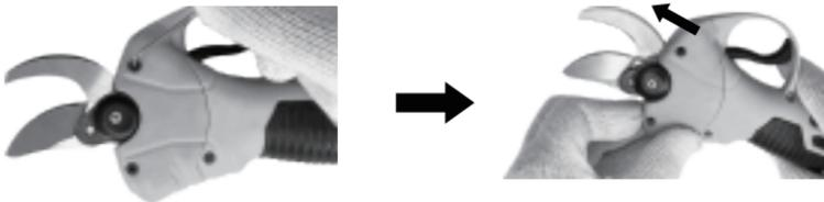
1. Verwenden Sie einen Inbusschlüssel, um die Schraube gegen den Uhrzeigersinn zu drehen und sie zu lösen. Entfernen Sie dann das Gehäuse.
