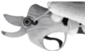
2. Verwenden Sie einen Inbusschlüssel, um die Schraube gegen den Uhrzeigersinn zu drehen und sie zu lösen. Entfernen Sie dann die gezahnte Unterlegscheibe.
