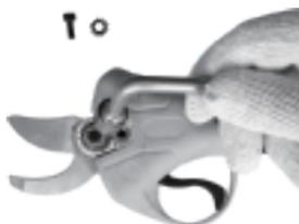
3. Verwenden Sie einen Sechskantschlüssel, um die Mutter gegen den Uhrzeigersinn zu drehen und sie zu lösen, dann entfernen Sie sie.
