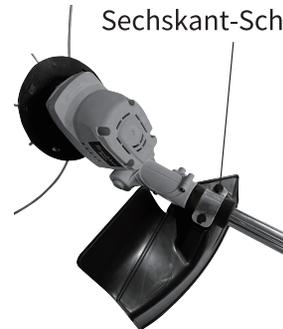
Um die Sicherheitsabdeckung zu installieren, stülpen Sie zuerst das schwarze Befestigungsgummi über das Ende der Aluminiumstange, befestigen Sie dann die Sicherheitsabdeckung auf dem schwarzen Gummi und ziehen Sie die beiden Sechskantschrauben an, um die Rückseite der Sicherheitsabdeckung zu befestigen.
