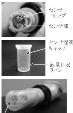
注) 保護溶液の代わりに、別の溶液・水道水などを使用すると故障の原因となりますので、絶対に避けてください。
