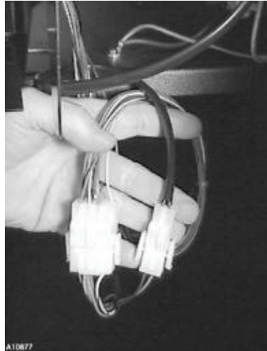
Figura 6b. Conecte el cordón umbilical de la CB300-SATL
