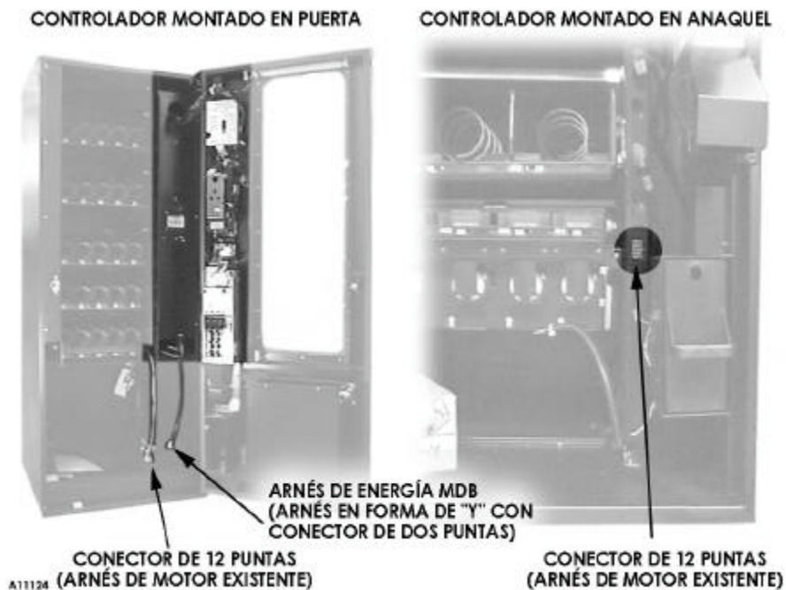
Figura 5. Localizaciones típicas de un arnés de motor de 12 puntas.
