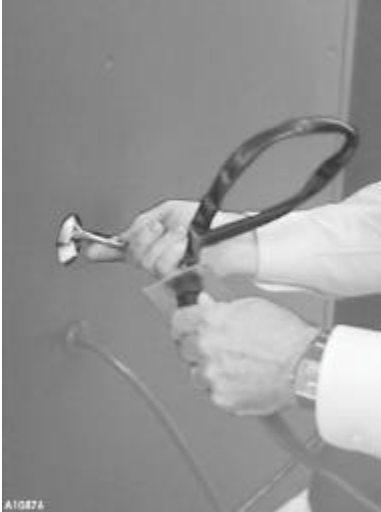
Figura 6a. Retire el tapón. Inserte el cordón umbilical
