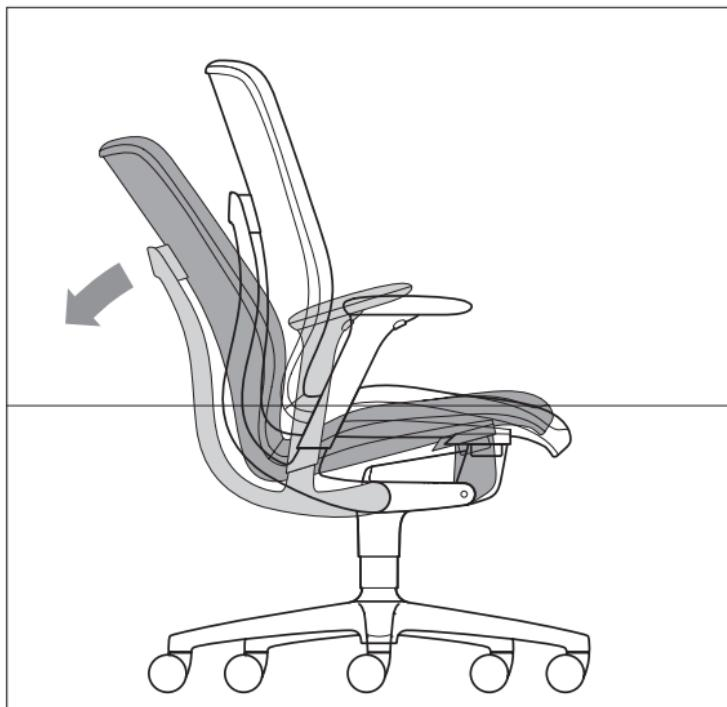
pour maintenir une position optimale du support lombaire. L'inclinaison latérale de l'ensemble assise-dossier est de 12° maxi. dans chaque sens. Un pré-ajustement de la force de rappel est proposé en option (10 positions possibles) pour répondre aux préférences spécifiques de l'utilisateur. Le siège est adapté à des gabarits allant de 45 à 120 kg.
