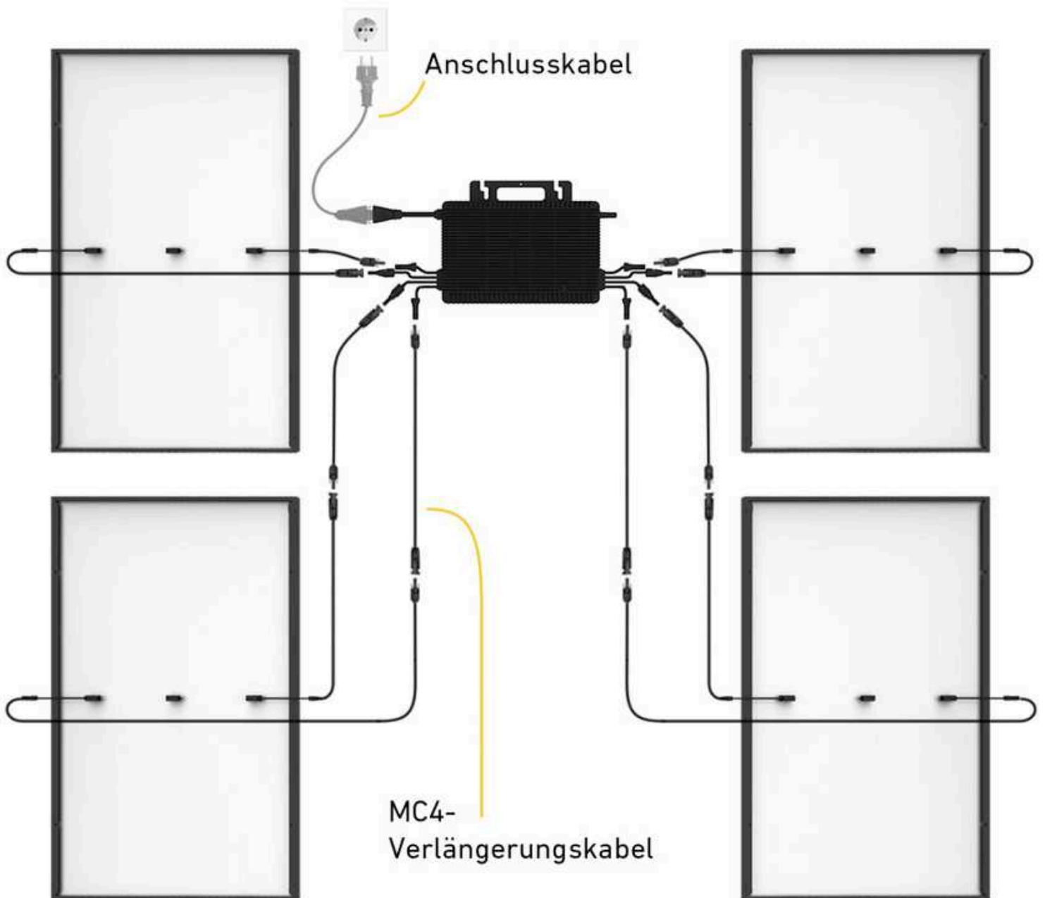
**Schritt 9.2:** Nutze die mitgelieferten Kabelbinder, um die Kabel des Solarmoduls an dem Modul zu befestigen. So verhinderst du, dass die Kabel direkt auf dem Dach aufliegen.
