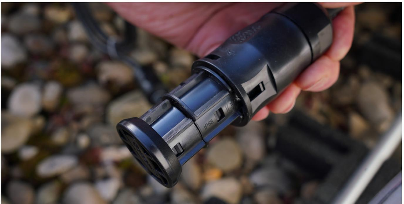
**Schritt 5:** Verbinde das mitgelieferte AC-Anschlusskabel mit dem langen Kabel des Wechselrichters.
