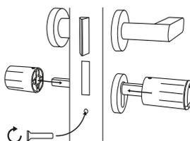
**Une incroyable facilité :** extraire l'ancien cylindre, le remplacer par le cylindre secuENTRY home et l'adapter à l'épaisseur de la porte, visser. Terminé !
