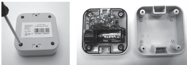
Abb. 2: Öffnen des Transponder Extenders
