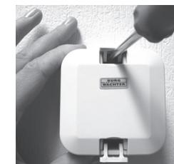
Abb. 5: Verschrauben des Transponder Extenders
