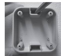
Abb. 3: Bohrposition anzeichnen
