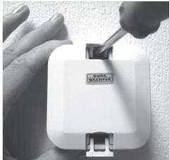
Abb. 7: Lösen des Transponder Extenders
