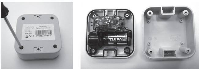
Abb. 8: Öffnen des Transponder Extenders
