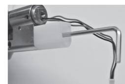
7 Sélectionnez l'adaptateur approprié selon le tableau 1. Faites passer le connecteur et pressez l'adaptateur sur le cylindre. Si nécessaire, vous pouvez aussi enficher en premier le support de montage puis pousser le connecteur à travers l'adaptateur. Attention : veuillez contrôler que l'allongement de cylindre est plus court que la surface d'appui de l'adaptateur.
