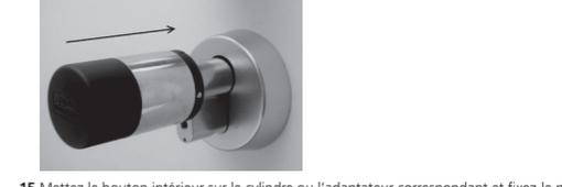
15 Mettez le bouton intérieur sur le cylindre ou l'adaptateur correspondant et fixez-le par la vis appropriée. Vous trouverez dans le tableau 1 les graduations adéquates.
