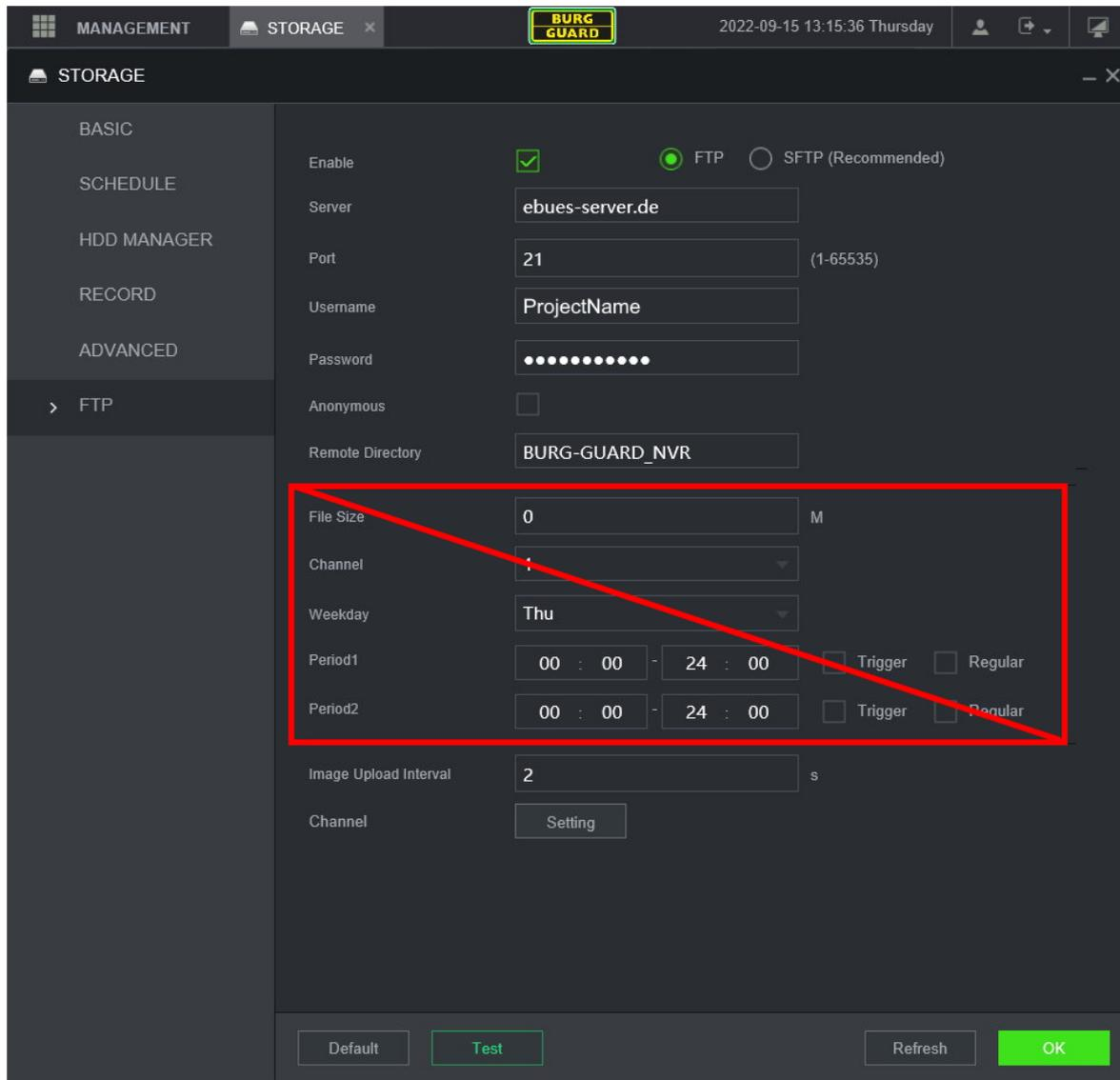
**Abbildung:** Konfiguration von BURG-GUARD-Bildquellen für den FTP Alarm Upload
