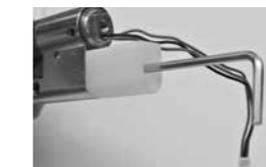
7 Sélectionnez l'adaptateur approprié selon le tableau 1. Faites passer le connecteur et pressez l'adaptateur sur le cylindre. Si nécessaire, vous pouvez aussi enficher en premier le support de montage puis pousser le connecteur à travers l'adaptateur. Attention : vérifiez que l'allongement de cylindre est plus court que la surface d'appui de l'adaptateur.
