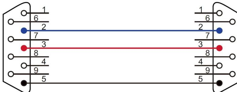
Wenn die Tastatur zur Steuerung anderer Geräte verwendet wird, nimmt RS232 Com den Crossover-Verbindungsmodus an: 2-3, 3-2, 5-5. Crossover-Verbindungsmodus:
