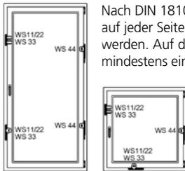
Nach DIN 18104-1 sollte je 1 m Fensterhöhe auf jeder Seite mindestens eine Zusatzsicherung montiert werden. Auf der Betätigungsseite (Griffseite) muss mindestens eine Zusatzsicherung abschließbar sein.
