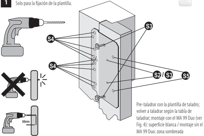
**2** Dependiendo de la altura del rebaje (a) utilice tornillos S2 o S3.
