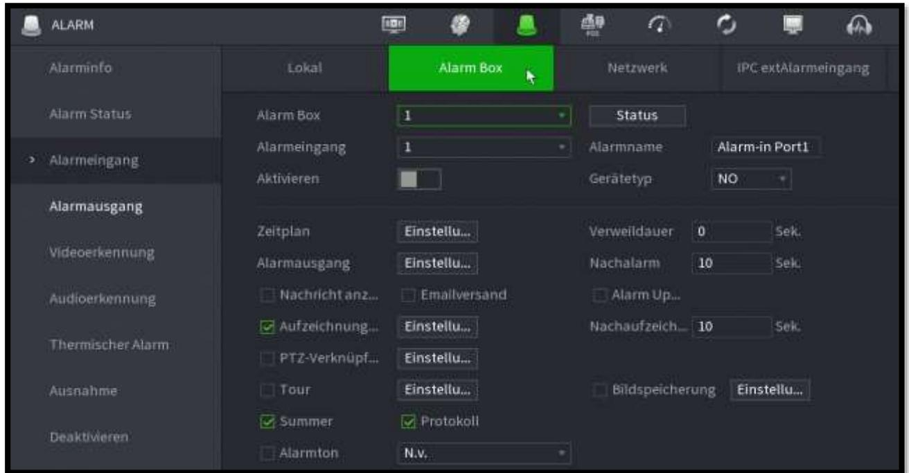
NO: Normally Open – Der Ruhezustand ist geöffnet. Wird der Kontakt geschlossen wird dies erkannt.
