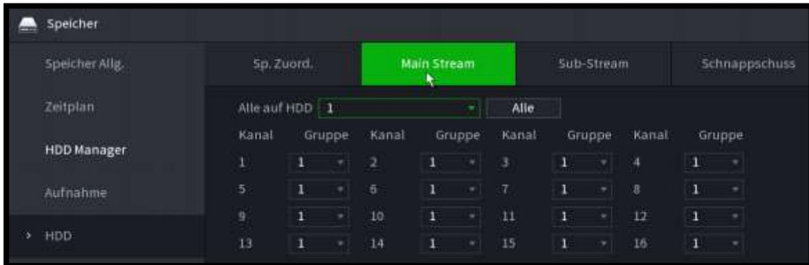
Wählen Sie aus der Drop-Down Liste welcher Kanal welcher HDD zugeordnet werden soll.
