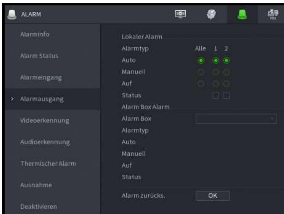
Um den Status manuell zu setzen klicken Sie in die Kästchen neben „Status“. Bei einem gesetzten Haken ist der Ausgang aktiv, bei einem leeren Kästchen ist der Ausgang deaktiviert.
