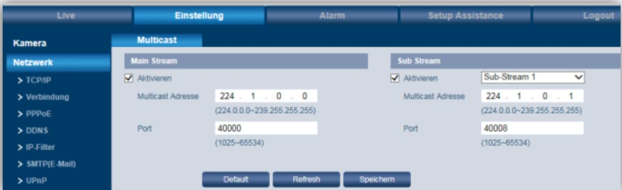
Multicast bezeichnet die Übertragung von Informationen von einem Punkt zu einer Gruppe (Mehrpunktverbindung). Hierbei werden zeitgleich Informationen an mehrere Teilnehmer oder eine Gruppe übertragen, ohne dass sich die hierfür verwendete Datenübertragungsrate beim Sender mit der Zahl der Empfänger multipliziert. Somit können Datenpakete effizient an viele Empfänger zur gleichen Zeit versendet werden. Dieses geschieht über spezielle Multicast IP-Adressen.
