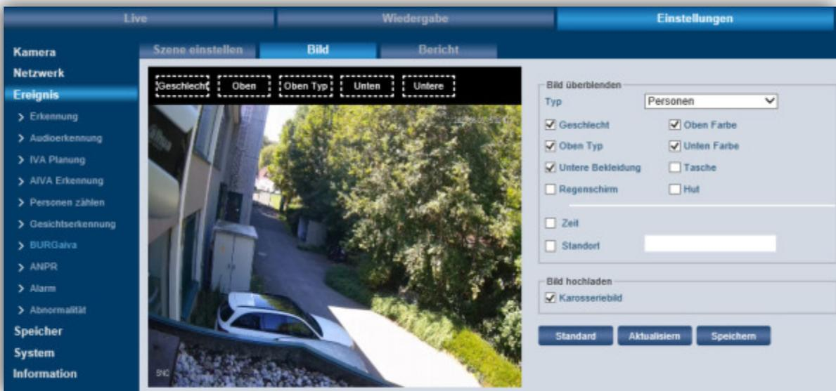
Die angegebenen Kriterien werden als Metadaten gespeichert und können später zur Suche (z.B. über den NVR) verwendet werden.
