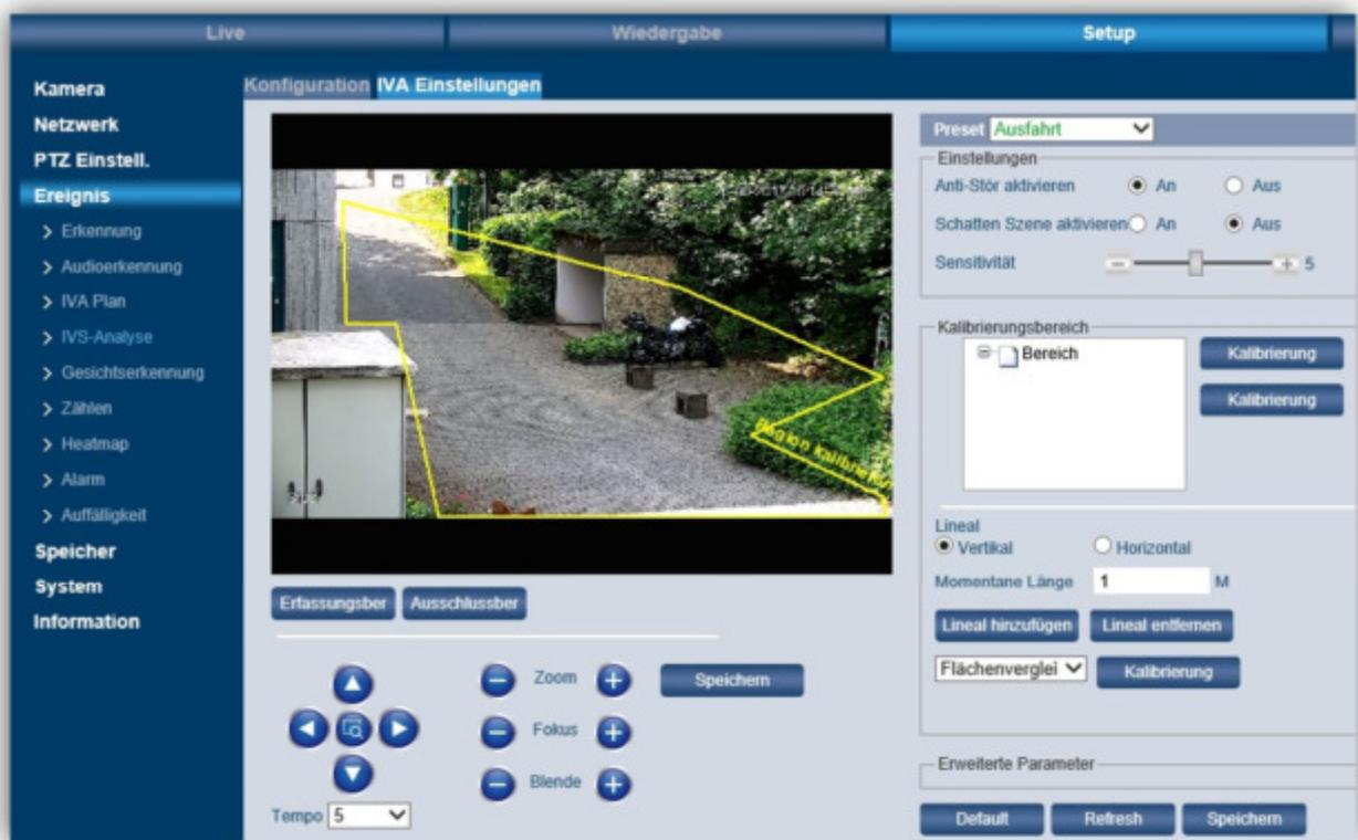
**Hinweis:** Wird kein Erfassungsbereich eingezeichnet, so wird angenommen, dass das gesamte Bild ausgewertet werden soll.
