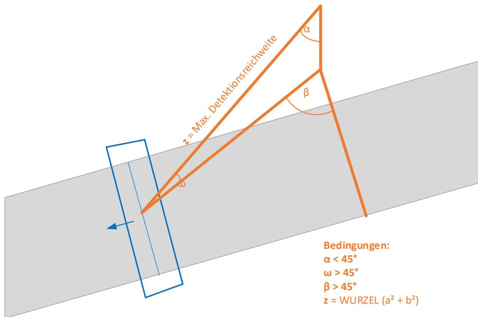
Abbildung 3: Detektionswinkel und max. Entfernung
