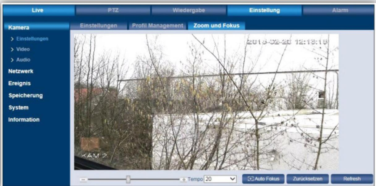
Hier können Sie für das Live-Bild die Schärfe (Fokus) einstellen. Klicken Sie hierfür auf Minus/Plus oder betätigen Sie den Schieberegler. Sie können die Einstellungsgeschwindigkeit einstellen (1, 5, 20). Über „Auto Fokus“ können Sie das Bild automatisch scharf stellen.
