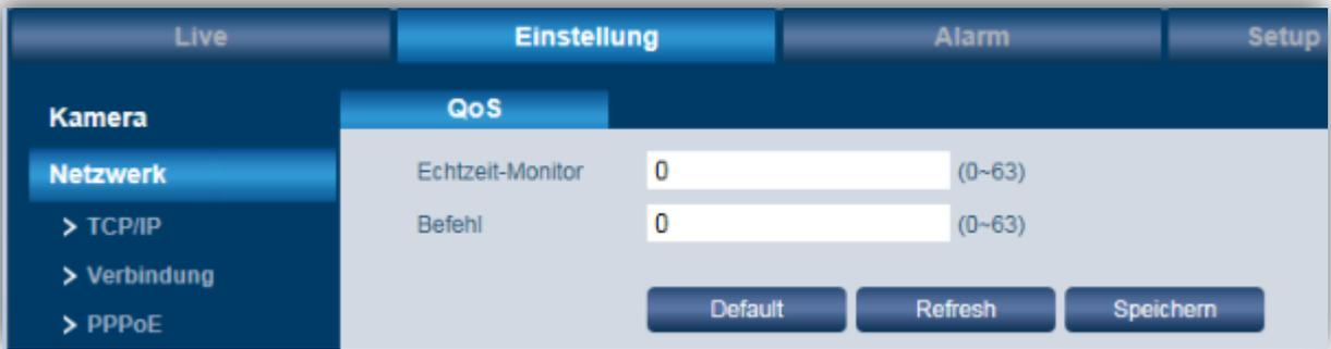
Durch QoS (Quality of Service) werden Datenpakete im Netzwerk-Traffic nach Dringlichkeit (Übertragungspriorität) übertragen, was besonders bei einer starken Auslastung oder gar Überlastung des Netzwerks von Wichtigkeit ist. Nach dem DSCP (Differentiated Services Code Point) Ansatz werden Datenströme anhand bestimmter Merkmale eingeteilt und mit DSCP gekennzeichnet. Diese erhalten dann eine bevorzugte Behandlung seitens des Routers.
