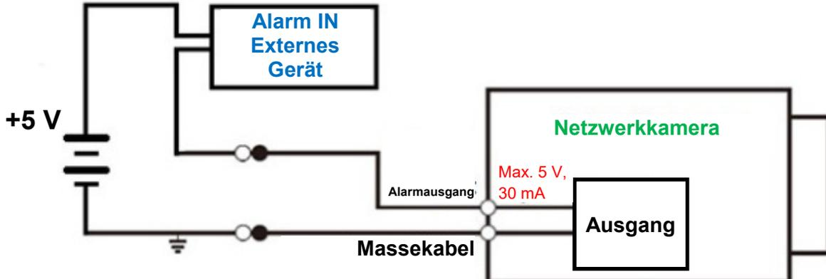
Der Alarmausgang dient der Versorgung des externen Schaltkreises.
