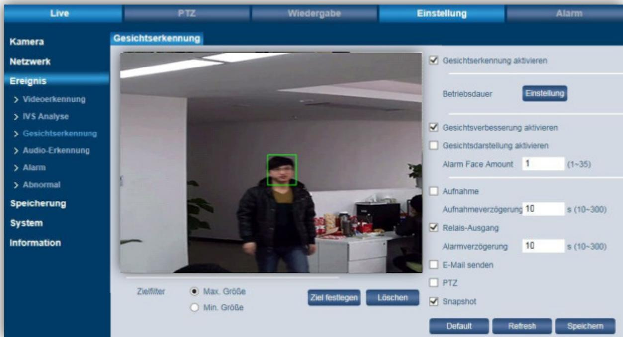
Je nach Kamera und Szene können bis zu 35 Gesichter gleichzeitig erkannt werden. Mit der Funktion „Gesichtszählung“ kann ein Alarm ausgelöst werden, wenn mehr Personen von der Kamera erkannt werden, als die eingestellte max. zulässige Anzahl.
