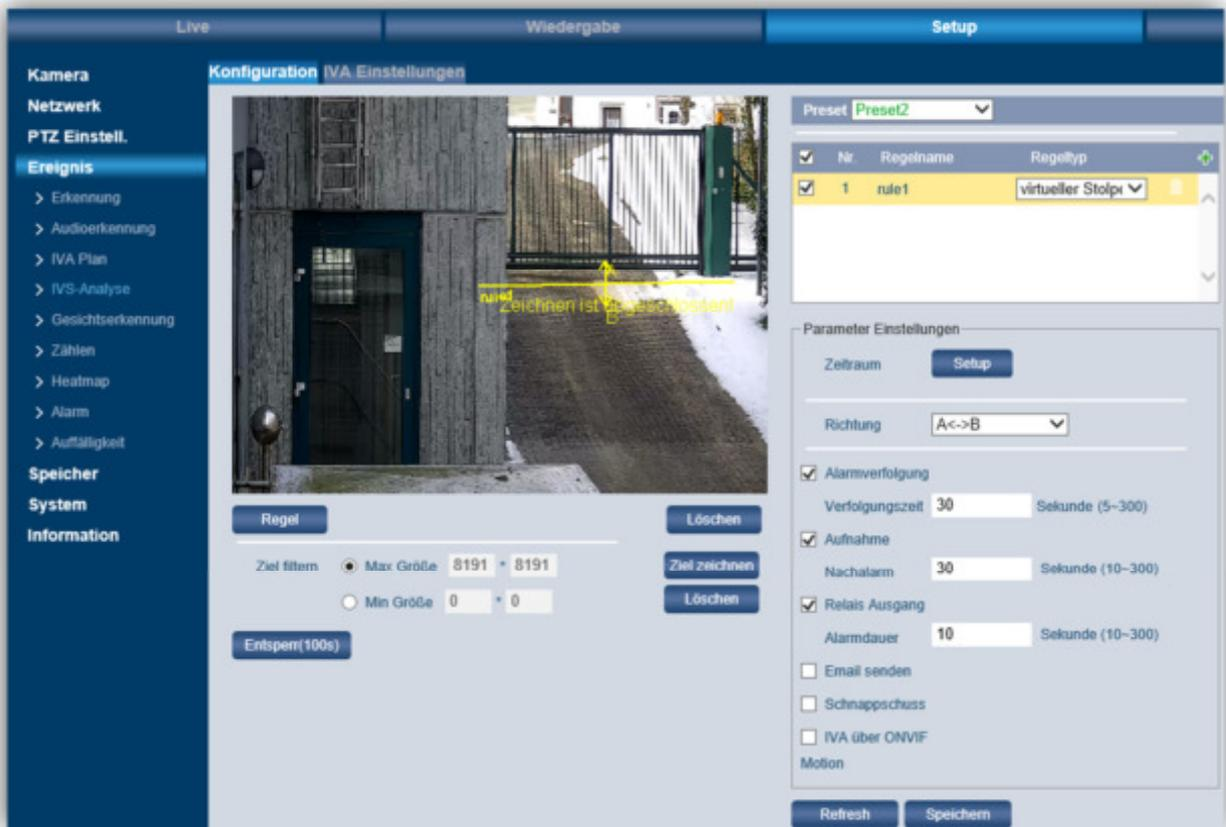
Beim „Stolperdraht“ zeichnen Sie eine Linie (= virtuellen Stolperdraht) an die Stelle ins Videobild ein, bei deren Überschreitung ein Alarm ausgelöst werden soll.
