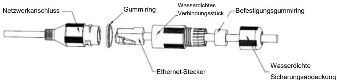
1. Installieren Sie den Gumming so im Netzwerkanschluss, dass die konvexe Vertiefung nach außen zeigt. Installieren Sie den Befestigungsgumming so im wasserfesten Verbindungsstück, dass das kleinere Loch nach außen zeigt.
