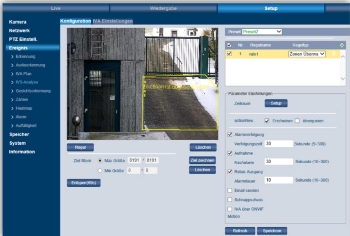
Mit „Regel“ zeichnen Sie einen Bereich ins Videobild ein. Ein Alarm wird ausgelöst, wenn jemand/etwas in den eingezeichneten Bereich eindringt und sich länger als erlaubt dort aufhält.
