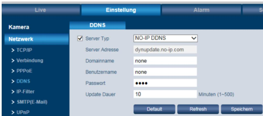
**DDNS** kann genutzt werden, um auf das System von außerhalb Ihres Netzwerks zuzugreifen. Hierzu ist die Anbindung an einen externen Server nötig.
