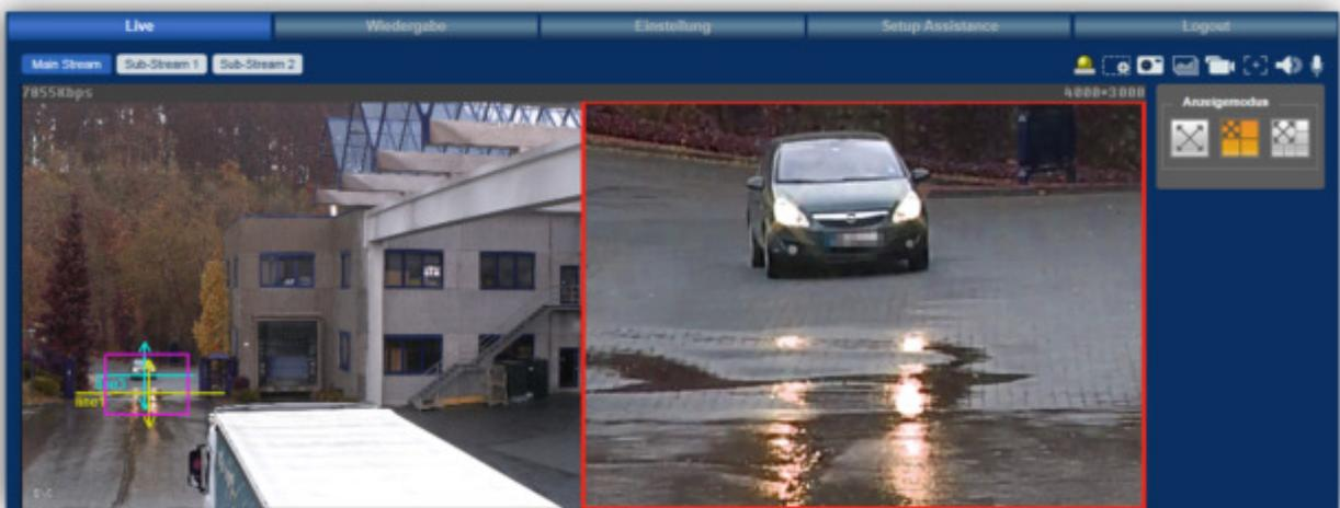
Beim Passieren des virtuellen Stolperdrahtes auf Höhe der Zufahrt (links) wird auf das Objekt herangezoomt (rechts). Das Objekt kann somit, ohne manuelles Eingreifen, identifiziert werden (Person, Nummernschild, Tier, ..)
