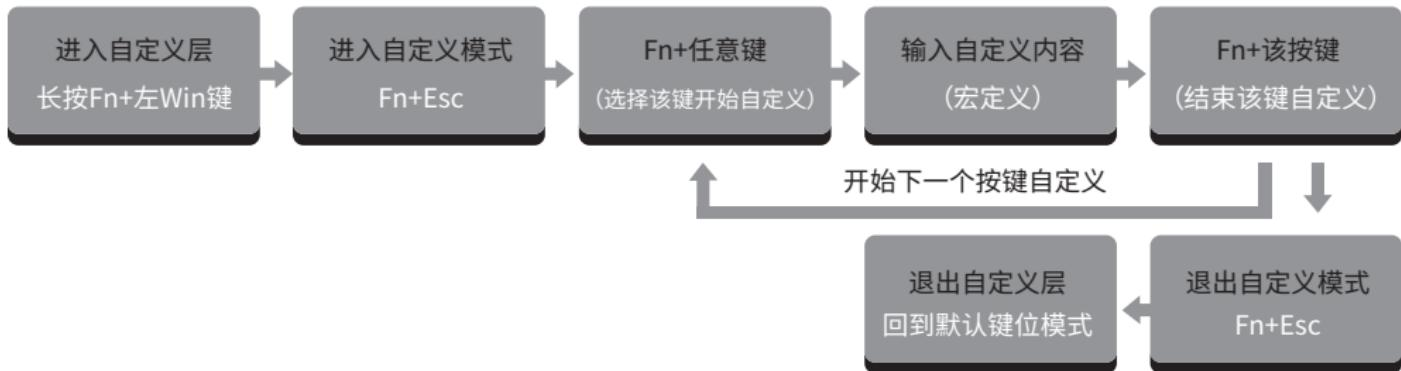
**清除宏：** 如果该按键已经进行了自定义，当进入自定义模式后，按下FN+该按键则会清除该按键的宏。如果要对该按键重新进行自定义，则在清除宏后再按照正常步骤按下FN+该键，开始自定义。
